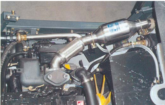
Application valve C8 avec catalyseur OSCA
